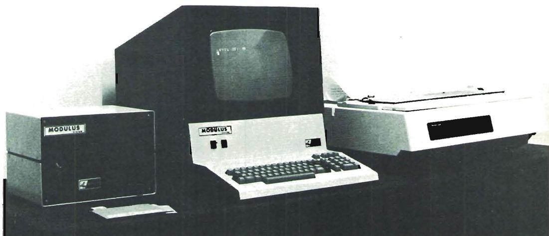
**Nuovo** : perché tecnologicamente avanzato. Impiega due microprocessori Z80. Software compatibile con tutti i sistemi basati sullo Z80 e 8080.
