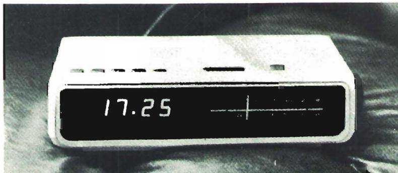
Questa situazione si può affrontare con relativa facilità aggiungendo il « Battery Back-up » costituito ad esempio da un oscillatore libero a 50 Hz e da una batteria tampone.
